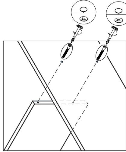
Отверстия диаметром 5 мм рассверлить сверлом диаметром 5 мм до сквозных.
